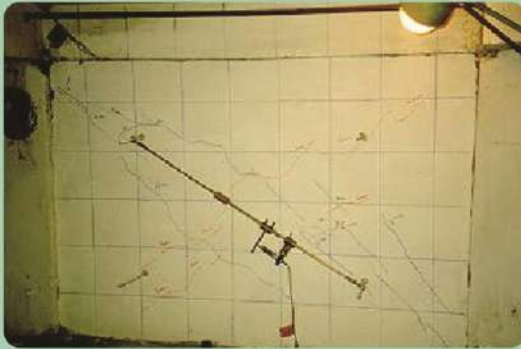
Zenon Panel duvar ile daha fazla yük alabilen çerçeve hasar görmemiştir
